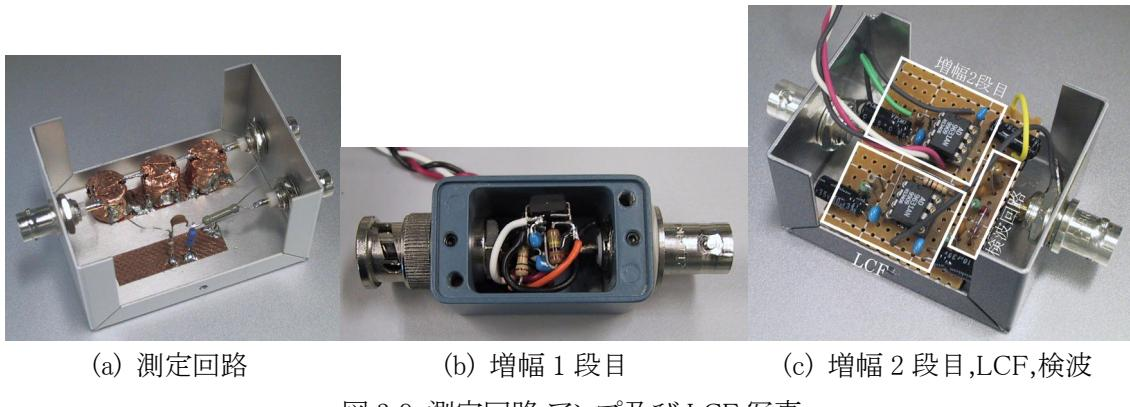
図 3.9 測定回路,アンプ及び LCF 写真
