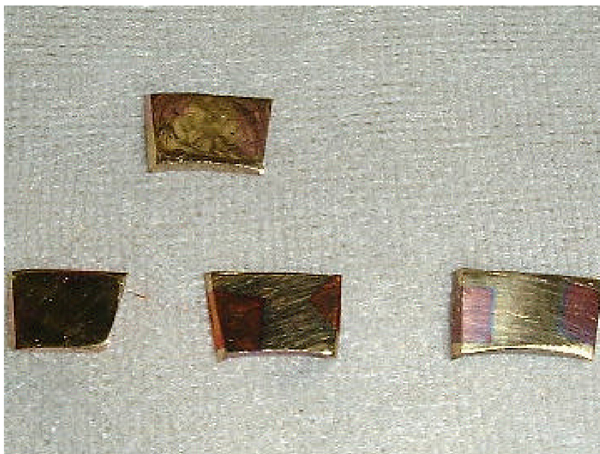
図 13 400 [K] にて熱処理後のサンプルと熱処理をしていないサンプル (下段左から 100 [s]、1000 [s]、10000 [s]、上段は熱処理をしていないもの。)
