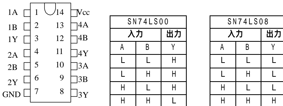
図 3.3.2 SN74LS00 と SN74LS08 の IC のピン配置図
