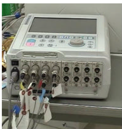
写真.3.3.1 圧縮荷重連続記録計 写真.3.3.2 ロードセル（圧縮荷重変換機）
