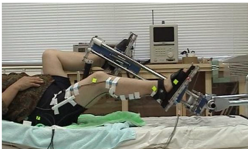
写真.3.3.13 関節計ゴニオメータを装着した写真
