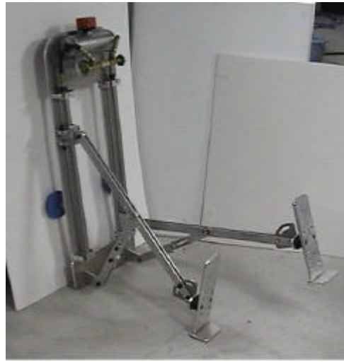
写真.3.2.1 油圧式足踏み運動装置
