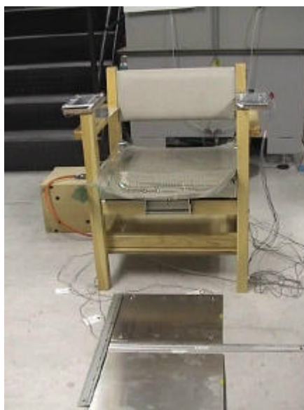
写真.2.2.22 座圧計、ロードセル取り付け状況
