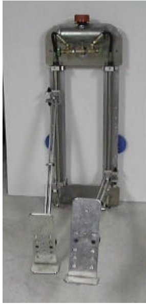
写真.3.2.1 油圧式足踏み運動装置
