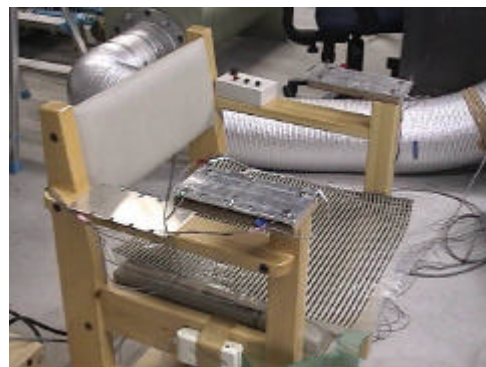
写真.2.2.21 手掌部ロードセル 及び尻部センサシート
