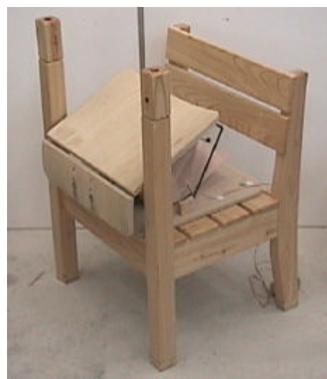
写真.2.2.1 エアバッグ式椅子（膨張前） 写真.2.2.2 エアバッグ式椅子（膨張後）
