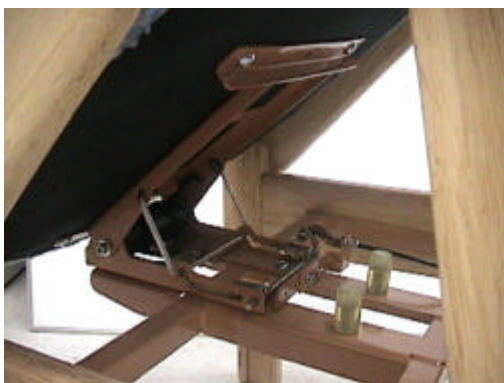
写真.2.2.11 バネ式椅子(座面下部)
