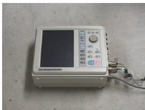
写真.2.2.15 圧縮荷重連続記録装置
