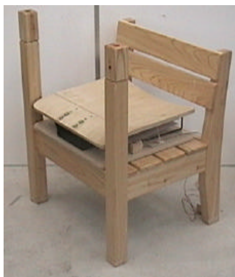
写真.2.2.1 エアバッグ式椅子（膨張前） 写真.2.2.2 エアバッグ式椅子（膨張後）
