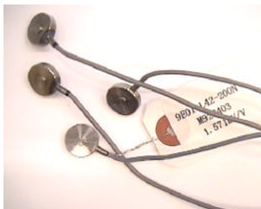
写真.3.3.1 圧縮荷重連続記録計 写真.3.3.2 ロードセル（圧縮荷重変換機）
