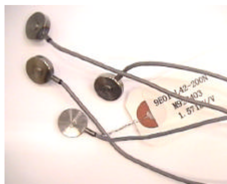
写真.2.2.16 圧縮荷重変換器
