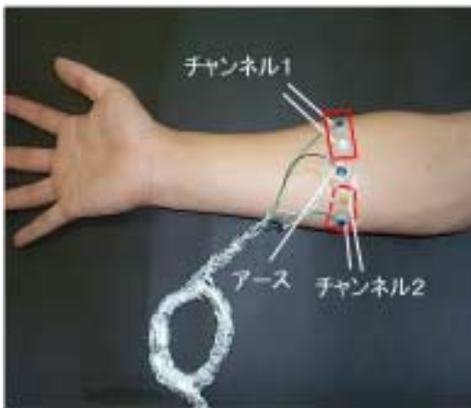
図 2.9 実験で採用した電極配置
