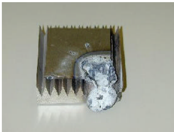
図6.4 溶解したチタン材料
