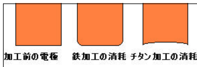
図7.6 銅電極の消耗の形状
