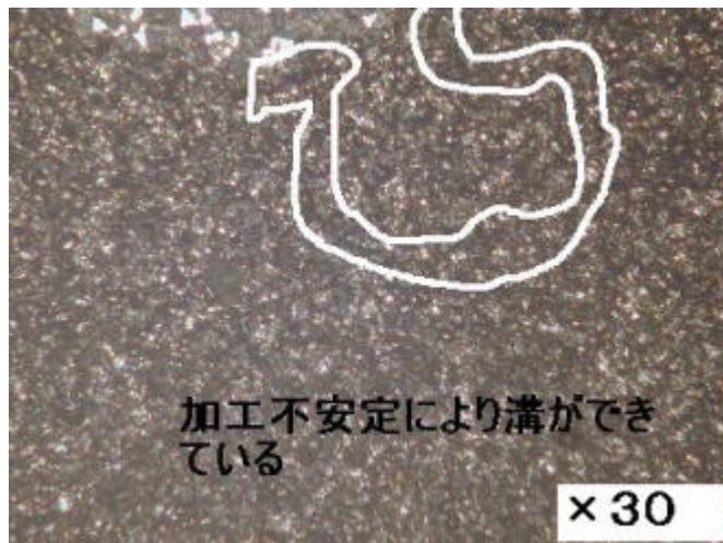
図 5.2 加工不安定状態となったチタン材料
