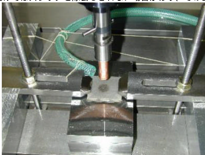
図4.1 上写真中のホースより加工液を噴出させる
