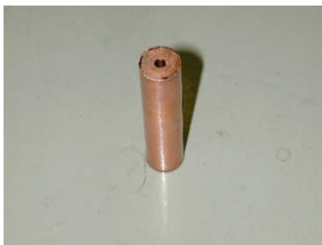
図3.2 実験に使用した電極形状
