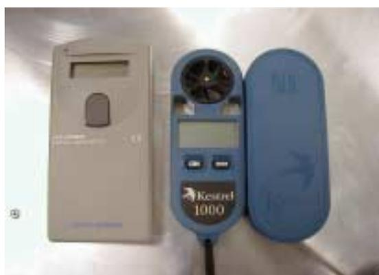
図 6.測定機器 2 (左・回転計、右・風速計)
