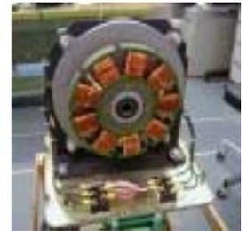
図7 新日本技研の1kW風力発電機(左羽根をはずした外観、右フードをはずした外観)
