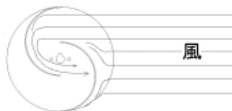
図 10. サボニウス風車の断面
