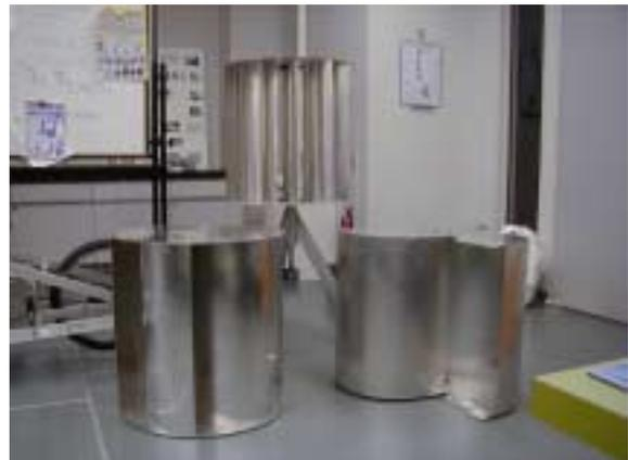
図 1 . 供試風車 ( サボニウス ・ クロスフロー )
