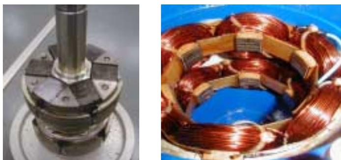
図 12 同上磁石を付けたロータ（2段）
