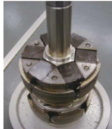
図 12 同上磁石を付けたロータ (2 段)
