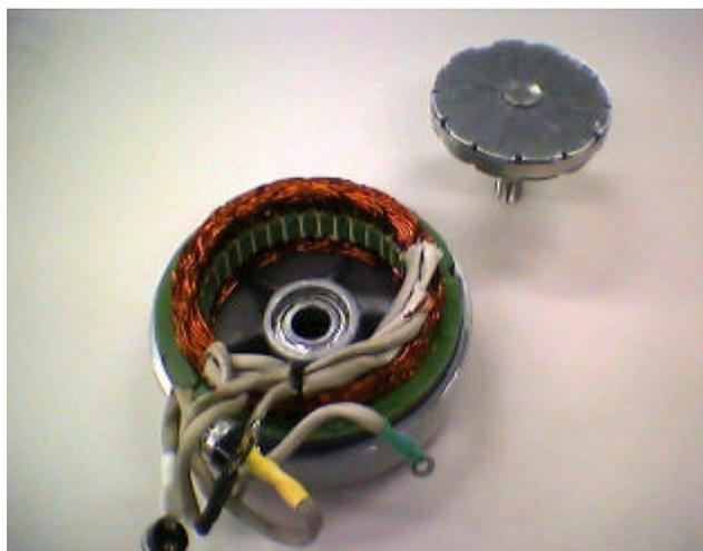
図4 Air403 内部構造
