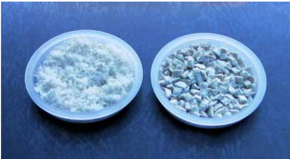
図 7 . 1 試料の形状（左は粉碎した試料，右がペレット状試料）
