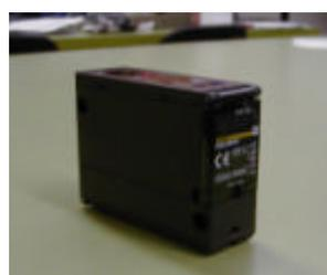
図5 光電センサー
