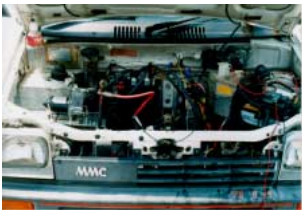
図.1-6 改造電気自動車エンジンルーム
