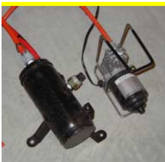
図.3-7 真空ポンプ・タンク
