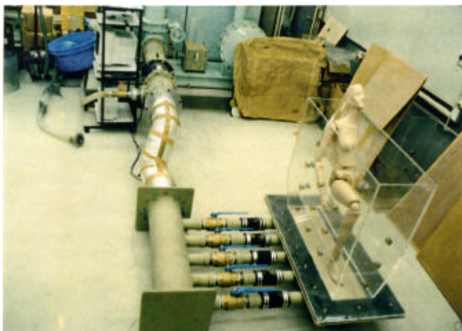
写真 2 半割浴槽実験装置
