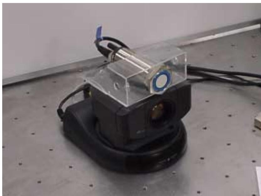
図 2.2 センサ取付カメラ
