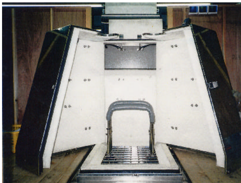
写真 6 粒体噴流化式身体洗淨試作機（浴槽内部）
