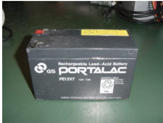
写真 1 9 D C 1 2 v , 7 A の鉛蓄電池
