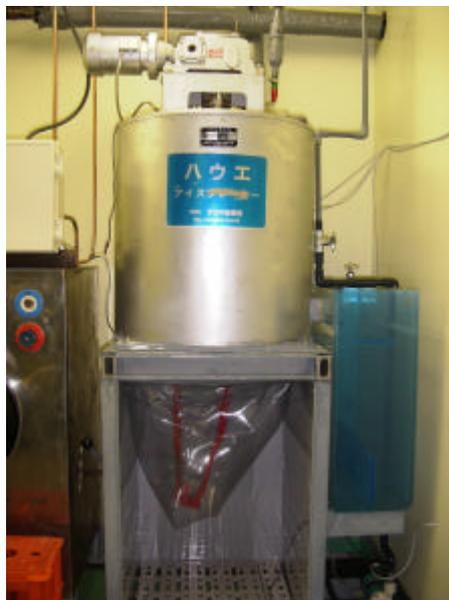
写真8 縦型掻き取り式装置
