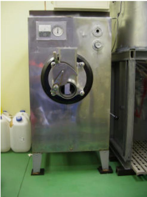
写真 9 横型円筒内壁攪拌装置
