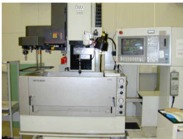
図 5.1 三菱形彫り放電加工機 DIAX VX-10
