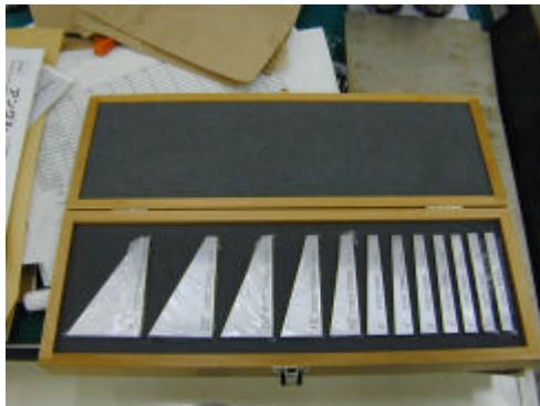
図 5.4 アングル ブロックゲージ (フジツール製)
