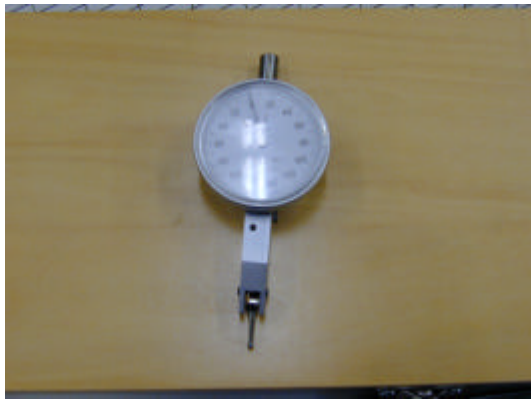
図 5.3 ダイヤルゲージ (TECLOCK 製)
