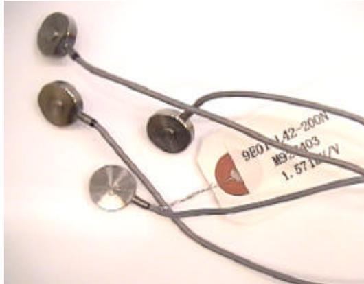
写真.3.1 圧縮荷重連続記録計 写真.3.2 ロードセル（圧縮荷重変換機）
