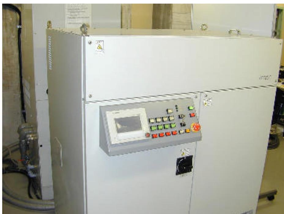
図 3.3 YAG レーザ発振器の外観
