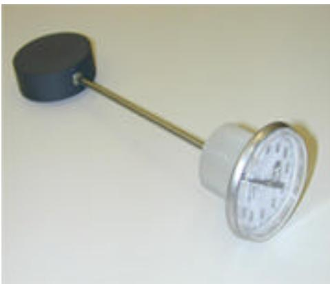
図 3.1 パワープローブの外観
