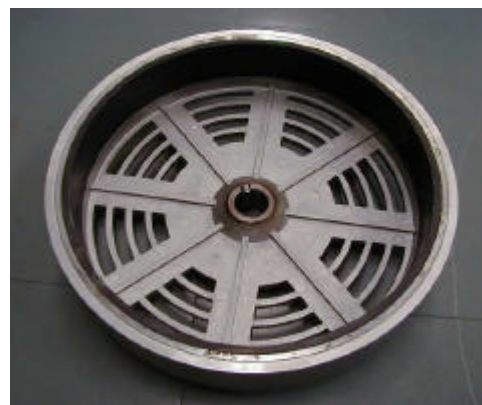
図9 ローター(内径に8個の磁石)
