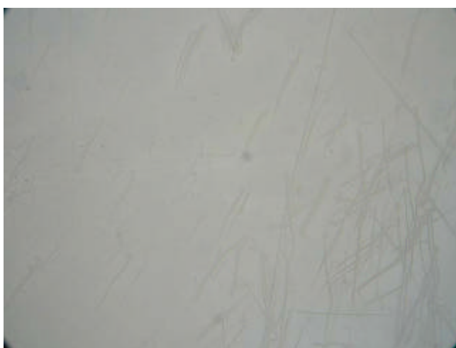
図 13 GaSb を \text{H}_2\text{SO}_4 で処理した表面
