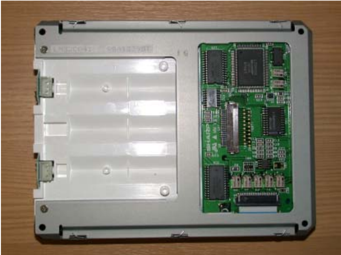
写真 2 液晶モジュールの裏
