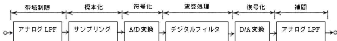
入力アナログ信号を A/D 変換器で標本化及び量子化してデジタル信号（時間軸上・振幅軸上も離散的な信号）を得る。このデジタル信号を所要のフィルタリング処理を行いその出力を D/A 変換器によってアナログ信号に戻す。これが一般的なデジタル信号処理の流れである。デジタル信号を処理する方法としてはソフトウェアによる演算によってフィルタ処理を行うのと NMOS、CMOS や LSI などのハードウェア素子を演算子に利用する方法がある。ここでは基本的なフィルタである FIR と IIR フィルタを検証することでデジタルフィルタの基本的な特性を調べる。
