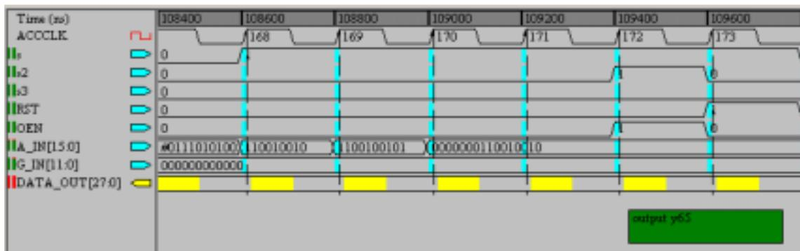
となり、これにより FIR フィルタが信号の処理を  $28T_s$  まで行う時間で IIR フィルタは  $65T_s$  まで処理が行われているのがわかる。
