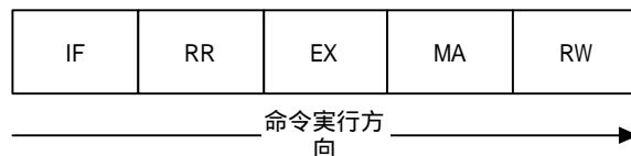
図2.1 命令パイプライン
