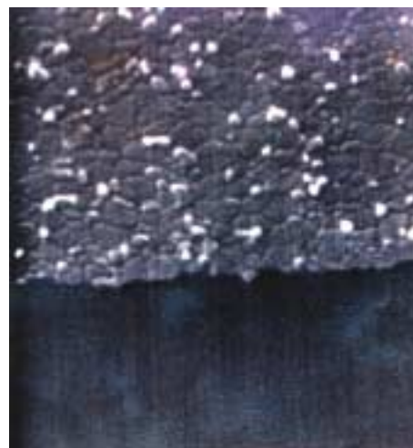
第3 - 6 図 熱酸化後の多結晶Si膜表面のSEM写真（酸化膜はエッチング）
