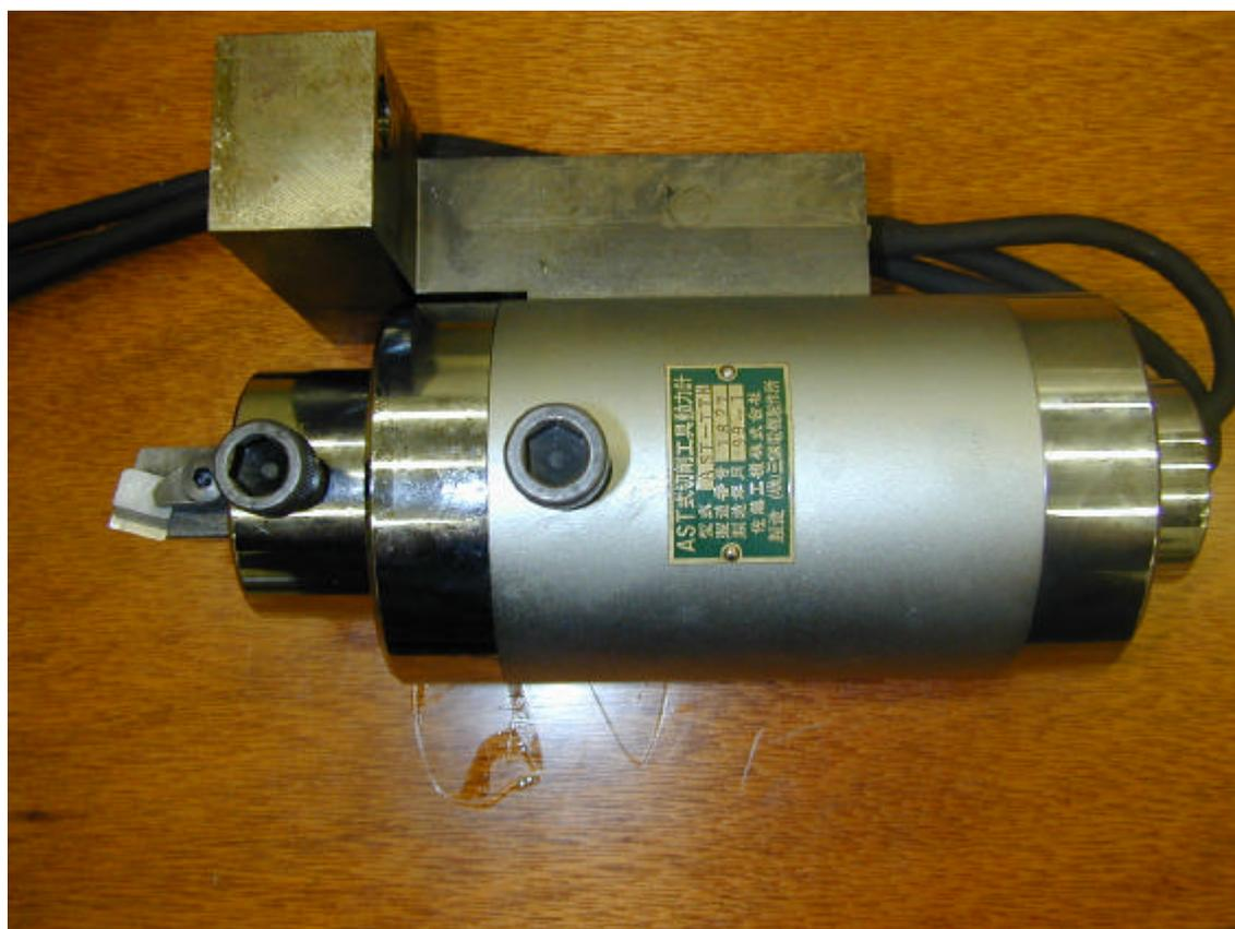
（図 3.1.4）3 軸力バイトホルダ型センサ <株式会社三保電機製作所製 AST 式工具動力計>
