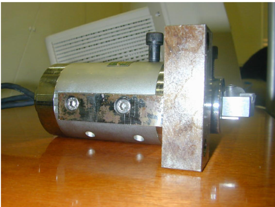
(図 3.2.3) 専用ステーを取り付けた 3 軸力バイトホルダ型センサ
