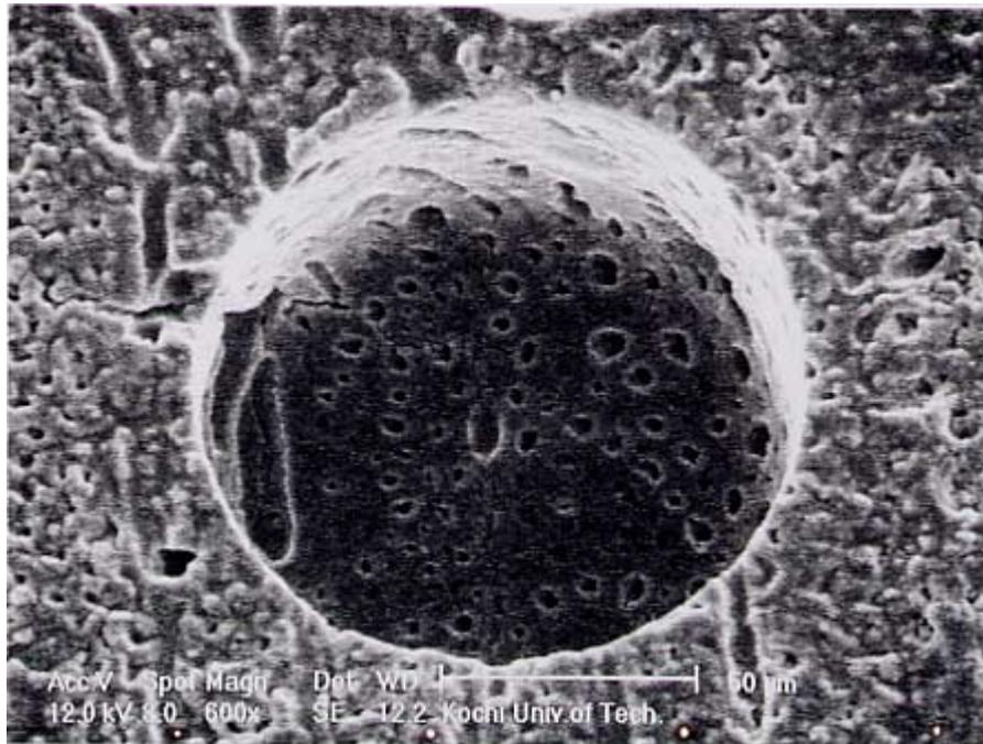
図3 リグナムバイタの穴加工結果
