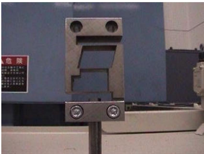
図 3.3.4 変形センサの本体部分
