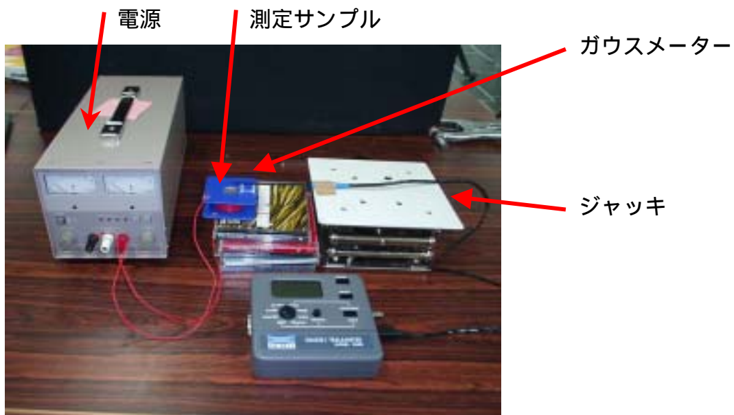
図4.1 サンプルの磁気特性の測定装置の配置
