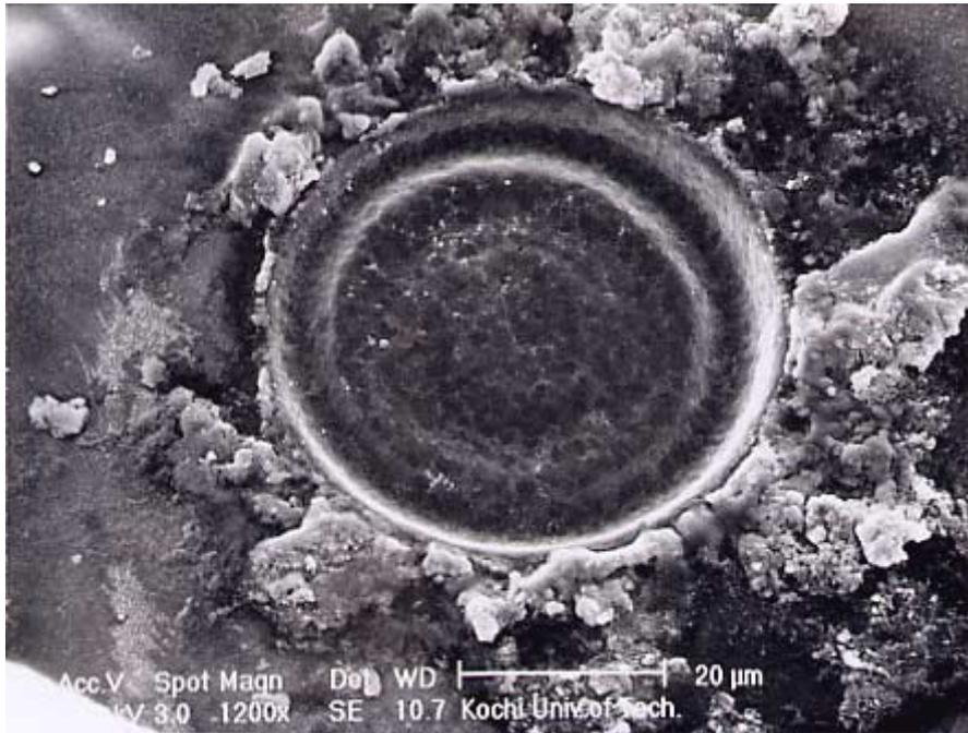
図 5.1 CVDダイヤモンドへの穴加工 10pF
