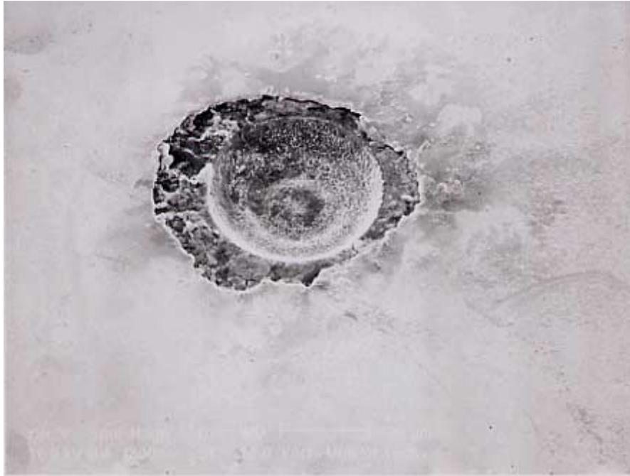
図 4.1 単結晶ダイヤモンド金蒸着面への穴加工
