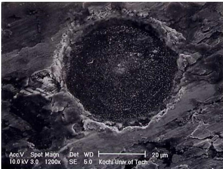
図 4.2 単結晶ダイヤモンド Ti-Al-Nb 溶着面への穴加工
