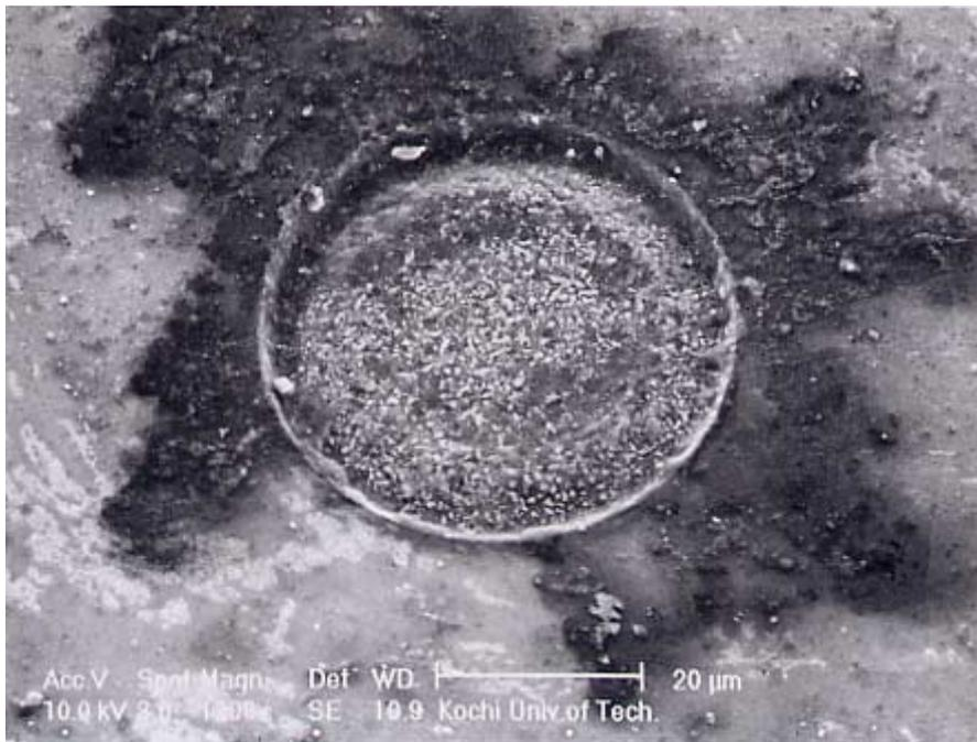
図 5.2 CVDダイヤモンドへの穴加工 100pF
