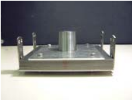
リターンヨークの底板を組みL字金具を付ける。
