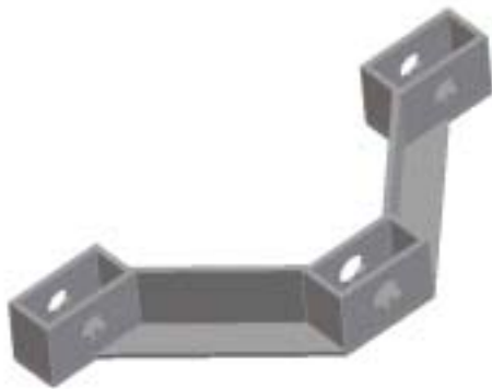
図 4.5 溶接し穴あけしたアーム
