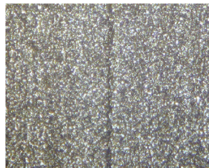
図 3.10 4th Cut による短絡をひき起こしている表面
