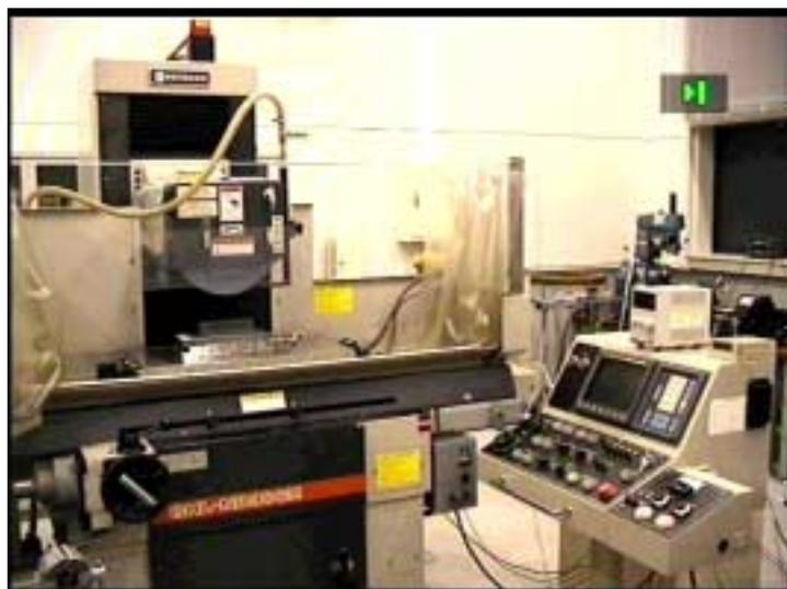
図 11 NC 平面研削盤の外観
