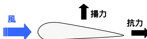
図 1. 揚力、抗力の発生原理
