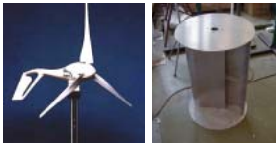
写真 4. セイルウィング式 (左) 写真 5. サボニウス式 (右)
