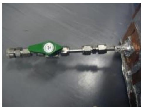
(b) ガス流量調整、開閉用バルブ
