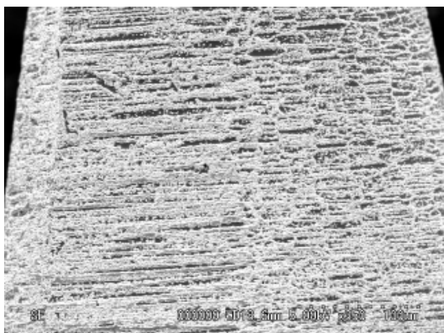
図 4-22：図 4-21 の拡大写真横溝に沿ってダイヤモンドが成長している。この針は中心の針で他の針よりダイヤの厚みがある
