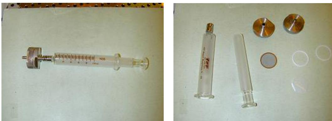
図4. 2 ステンレスシリンジホルダー
