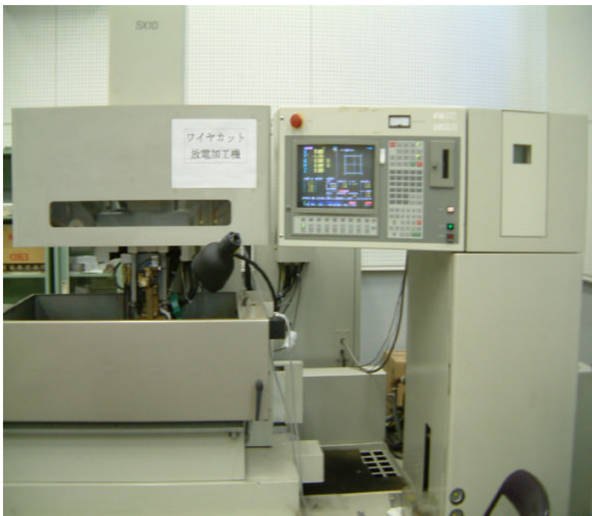
図 4-4 三菱社製ワイヤカット放電加工機 SX10
