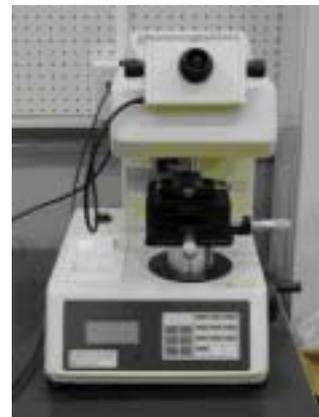
図 3.9 微小硬度計の外観
