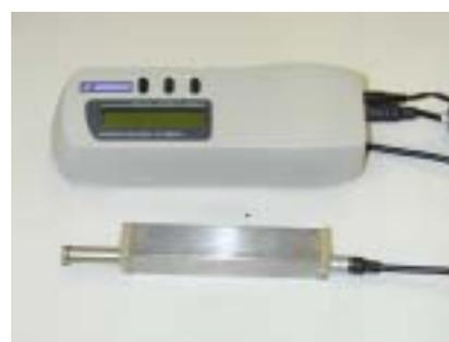
図 3.8 表面粗さ形状測定器の外観
