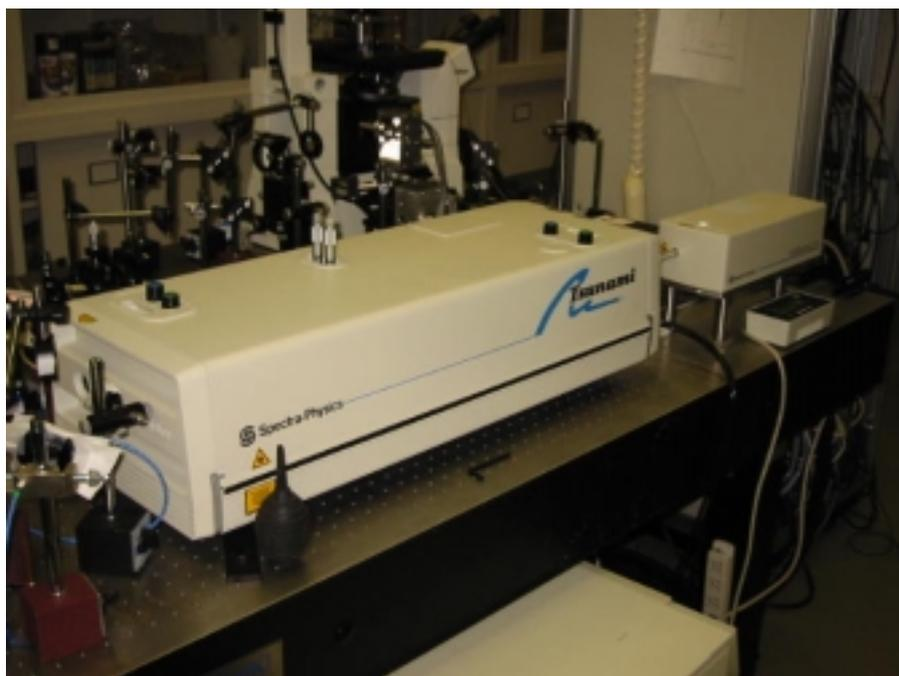
図 3.2.1 Ti:Sapphire フェムト秒レーザー
