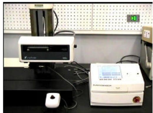
図 13 表面粗さ形状測定機
