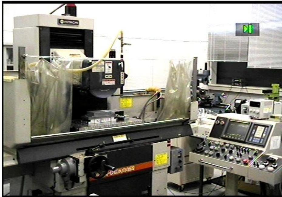
図9 NC平面研削盤の外観
