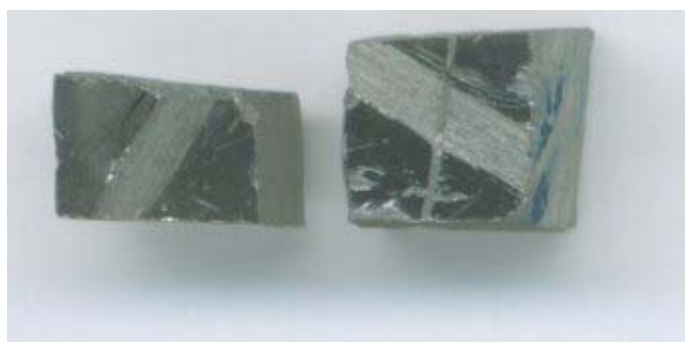
Fig.14 切り取った GFRP の傷
