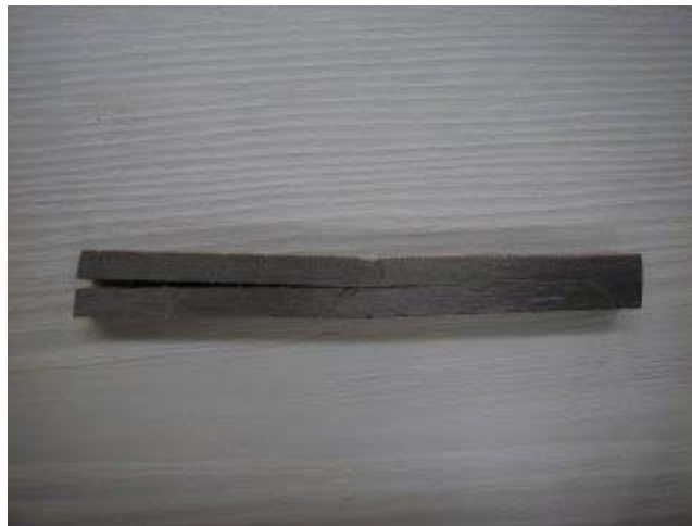
Fig.23 試験後の GFRP 試験片の破壊状況
