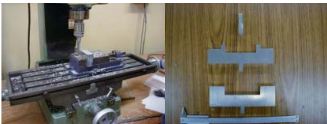
Fig.18 3点曲げ試験用治具の製作の様子と完成した治具
