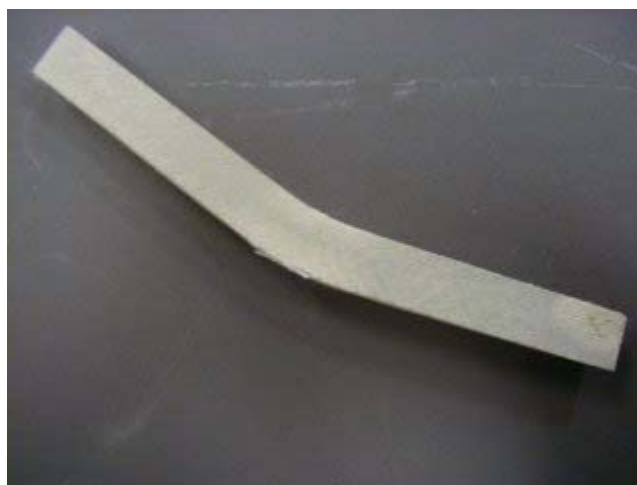
Fig.21 試験後のGFRP試験片の破壊状況
