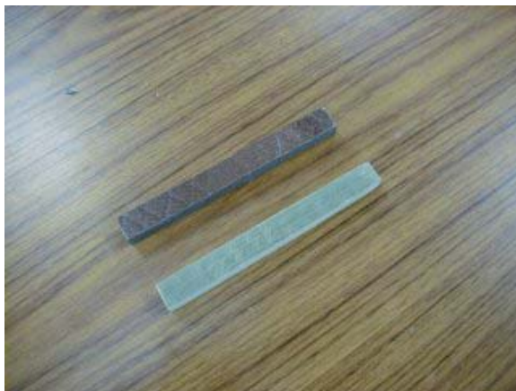
Fig.17 切り出した CFRP（上）と GFRP（下）の試験片
