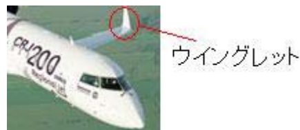
Fig.2 カナダ・ボンバルディア・エアロスペース社の CRJ200 のウイングレット (8)
