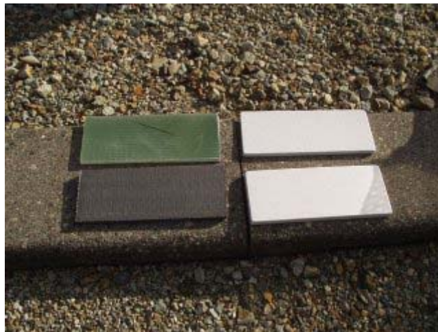
Fig.7 4枚の試験片(左上が無垢のGFRP、左下が無垢のCFRP)
