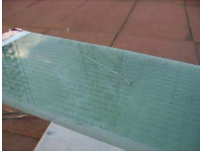
Fig.11 試験後の GFRP 試験片
