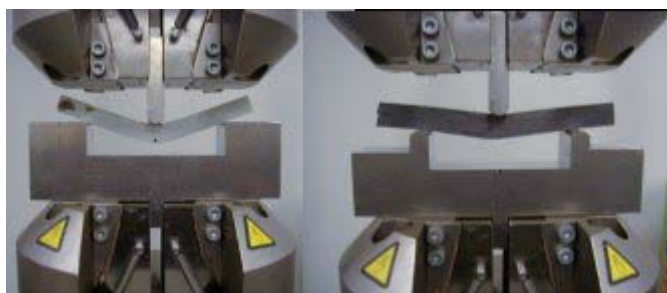
Fig.20 試験終了直後のGFRP試験片(左)とCFRP試験片(右)
