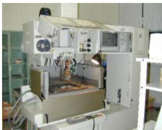
図 2.2 ワイヤ放電加工機の外観
