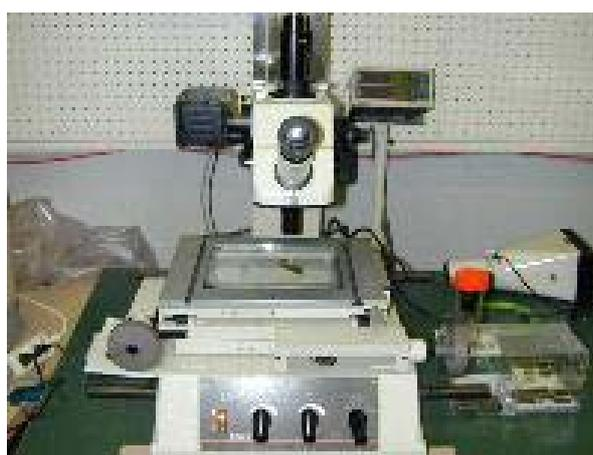
図 2.3 測定顕微鏡の外観写真
