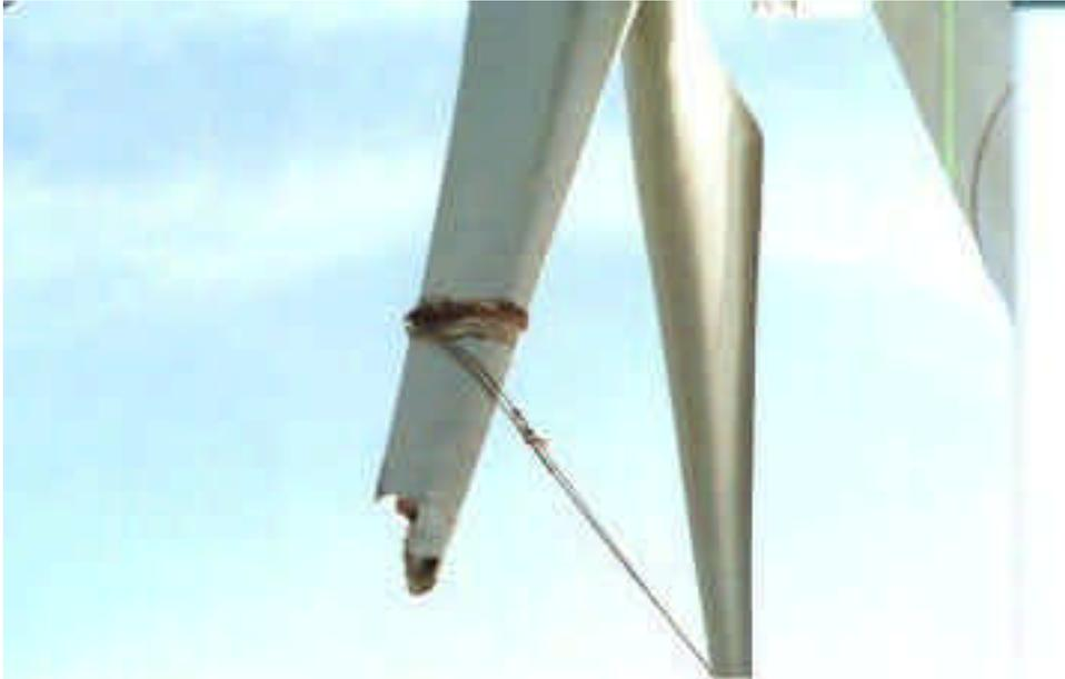
図 1-2 破損したブレード(大豊町の風力発電機の例)
