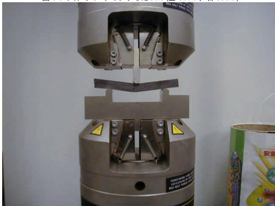
図 4-2 CFRP の強度実験
