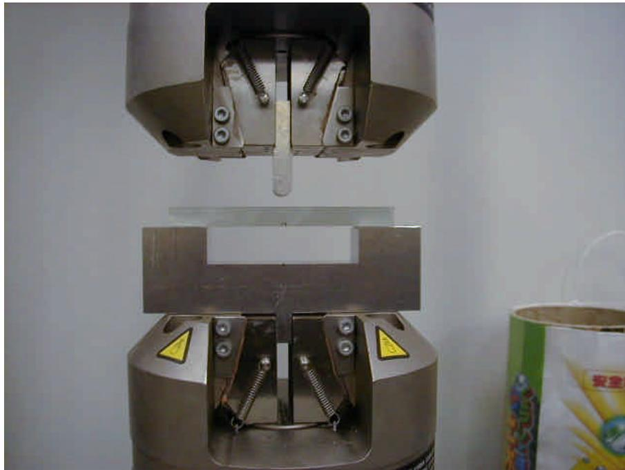
図 4-3 GFRP の強度実験
