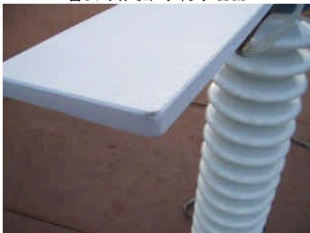
図 3-8 アルミコーティング CFRP 試験片
