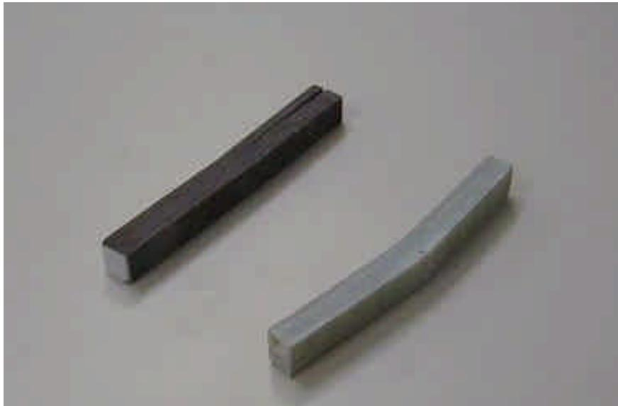
図 4-4 強度試験後の FRP(左 CFRP、右 GFRP)
