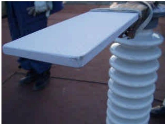
図 3-7 アルミコーティング GFRP
