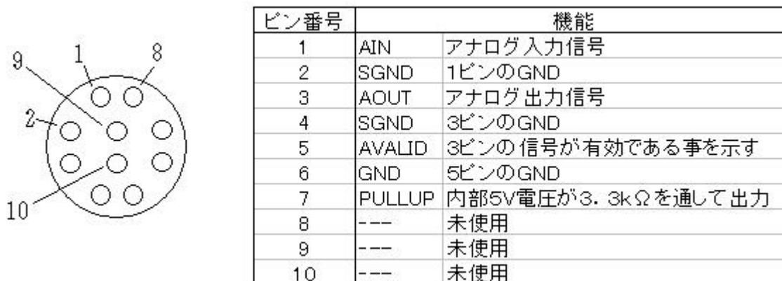
図 1 4 external 出力用コネクタと入出力信号
