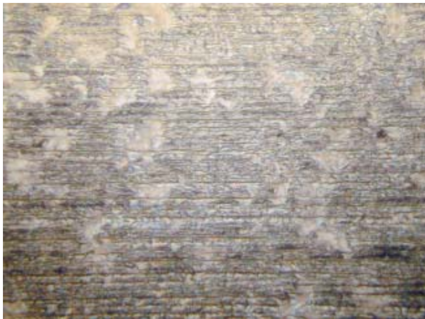
図 3.41 放電荒加工面 25\ \mu\text{m}/\text{Ry} を超高速回転ミーリングで切り込み量 35\ \mu\text{m} 加工した顕微鏡写真
