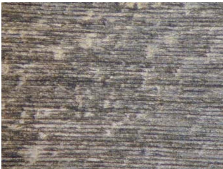
図 3.4 放電荒加工面 15\ \mu\text{m}/\text{Ry} を超高速回転ミールリングで切り込み量 20\ \mu\text{m} 加工した顕微鏡写真
