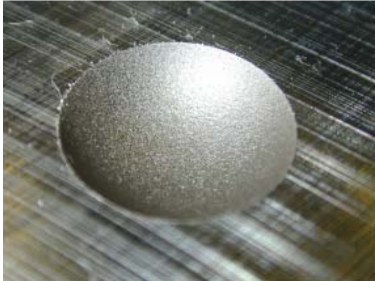
図 6.5 放電荒加工面 15\text{ }\mu\text{m/Ry} の表面写真
