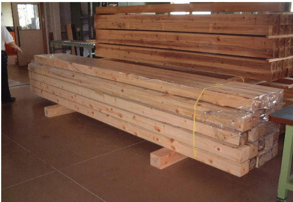
Fig3-3-6 実験で用いたヒノキ材
