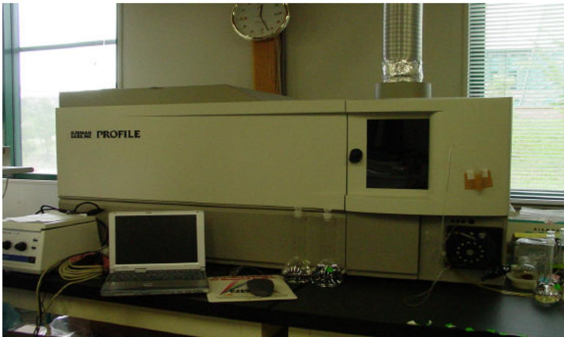
Fig2-2-1 誘導結合プラズマ発光分析装置(ICP)
