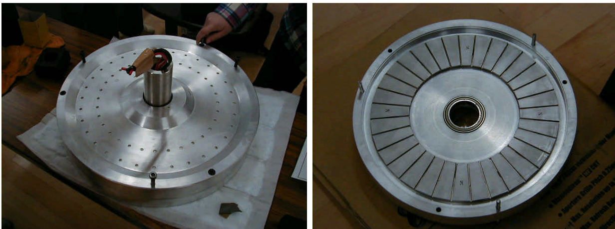
図 18 450mm 発電機外観と磁石配置
