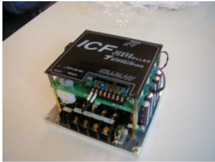
図 14 ツシマエレクトリック社製 DC スピードコントローラ
