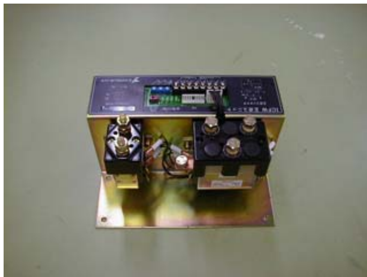
図 14 ツシマエレクトリック社製正逆転ユニット
